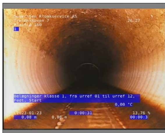
Foto: 10_1_3_23012023_144350_1.JPG 0,08m, Belægninger klasse 1, fra urref 01 til urref 12, Fedt, Start
