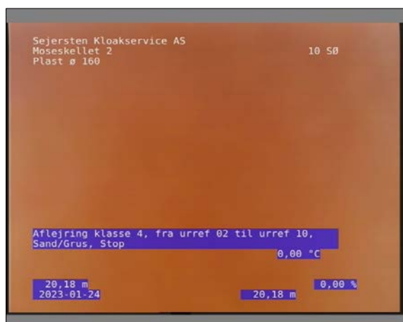
Foto: 11_1_18_24012023_081829_1.JPG 20,94m, Aflejring klasse 4, fra urref 02 til urref 10, Sand/Grus, Stop / Fejl i skærmtekst metermål
