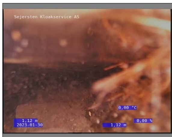
Foto: 31_1_10_30012023_141135_1.JPG 1,12m, Rødder klasse 3, fra urref 02 til urref 05, Rodklump, Start
