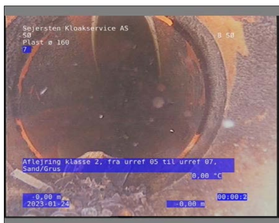
Foto: 16_1_3_24012023_134814_1.JPG 0,01m, Aflejring klasse 2, fra urref 05 til urref 07, Sand/Grus
