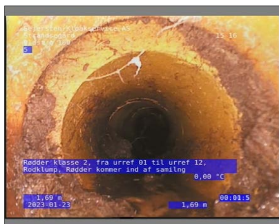
Foto: 5_1_4_23012023_084203_1.JPG 1,69m, Rødder klasse 2, fra urref 01 til urref 12, Rodklump / Rødder kommer ind af samling
