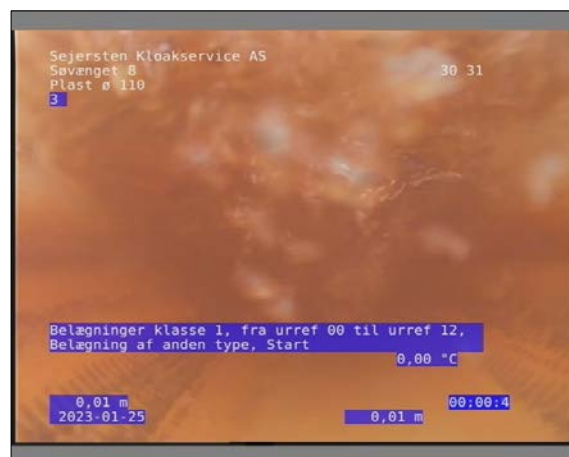
Foto: 17_1_3_25012023_085553_1.JPG 0,01m, Belægninger klasse 1, fra urref 00 til urref 12, Belægning af anden type, Start
