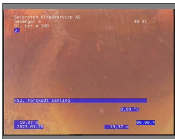
Foto: 17_1_17_25012023_091622_1.JPG 19,37m, FS2, Forskudt samling
