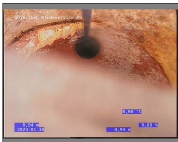
Foto: 30_1_6_30012023_125530_1.JPG 0,94m, FS3, Forskudt samling
